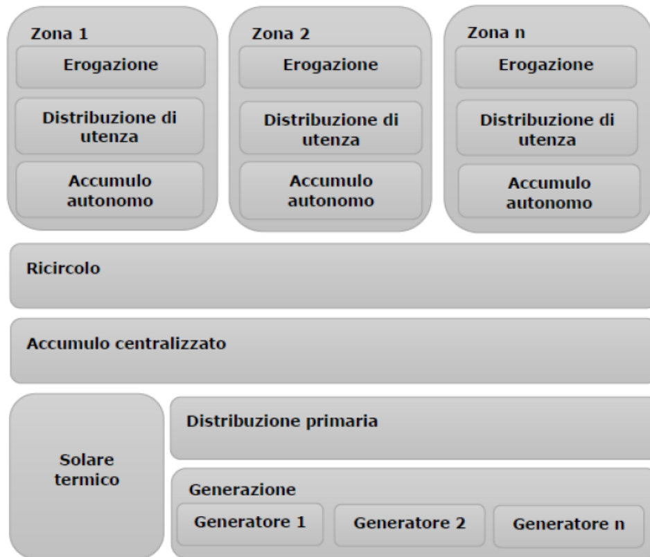
Figura 3 Schema di flusso rappresentativo di un impianto di ACS
