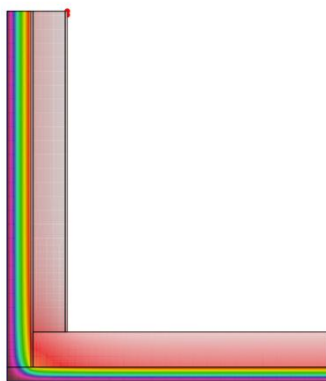
Z6 – Innesto ad angolo tra parete esterna (facciata) e solaio rialzato inferiore attestante su esterno
